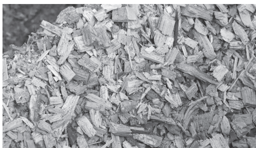
バイオマスボイラーの燃料になる木質チップ
